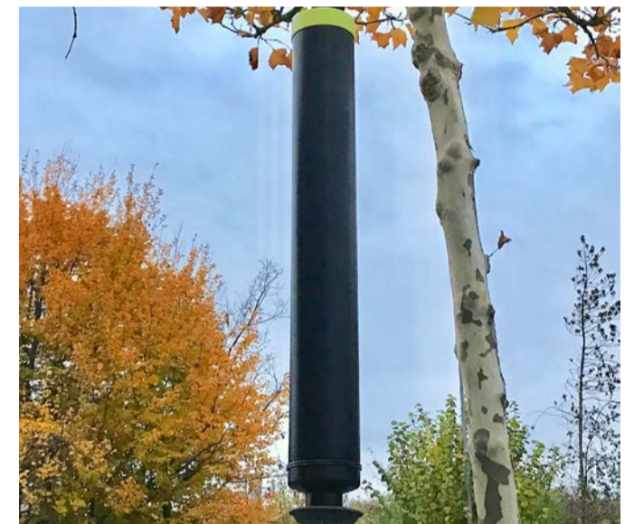
Bei jedem Sanitärunternehmen liegen Reste von Abwasserrohren herum. Eine trichterartige Verjüngung kann dort gleich angeschweisst werden. Ein Unterteller dient als Dreieckleiste (Futterauslass) und eine Gewindestange hält alles zusammen. Diese gibt es in jeder Eisenhandlung oder im Baumarkt.
